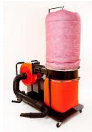
Рис.1 Установка вакуумной пылеуборки УВП-7
